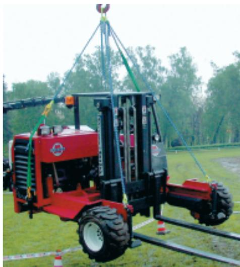
使い方によっては左写真のように巻き吊りにも応用可能。作業の幅が広がります!
